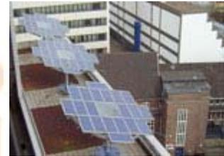
Solarzellen auf dem 80 Quadratmeter großen Runddach der 27 Meter langen **Alster Sonne** erzeugen Sonnenenergie, die in wartungsfreien Batterien zwischengelagert und an die beiden Elektromotoren sowie das Bugstahlruder und andere Stromverbraucher abgegeben wird. Bei längeren Fahrpausen wird der erzeugte Solarstrom in das öffentliche Netz eingespeist.
